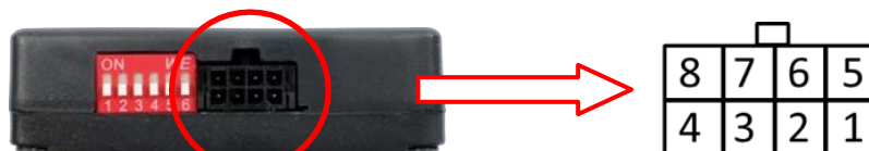
Przyporządkowanie pinów męskiego złącza 8-stykowego TV-500
